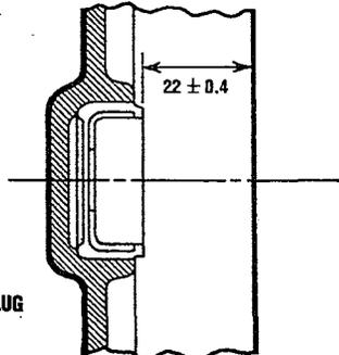
PRESS-FIT HEIGHT OF CAMSHAFT THRUST PLUG
